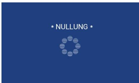
Der Messtaster verfährt mit 2,5mm/sec auf den Messtisch und verweilt dort für 2 sec, bis an dieser Stelle der Messsensor auf "0,000" gestellt wird.
