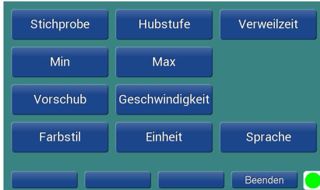
**Stichprobe** = Anzahl der zu messenden Messpunkte (bei Automatik Messung)
