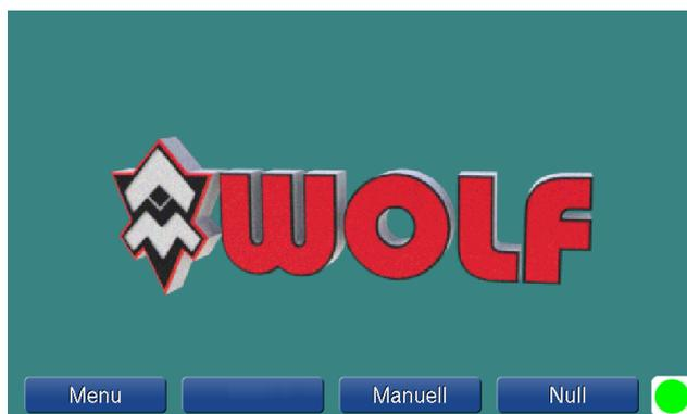
Solange keine Messdaten vorhanden sind, wird das Logo im Hintergrund dargestellt. Sind Messdaten vorhanden wird der letzte Messwert und die statistischen Werte der letzten Messreihe angezeigt. Betriebsanzeige (unten-rechts) zeigt den derzeitigen Zustand des Messgerätes an. (Grün -> bereit für eine Messaufgabe / Rot -> Messgerät befindet sich in einer aktiven Messung)
