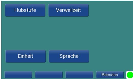
**Hubstufe** = Bestimmt den Anhub (bezogen auf der Ebene des Messtisches, in mm) des Messtasters nach einer Messung.
