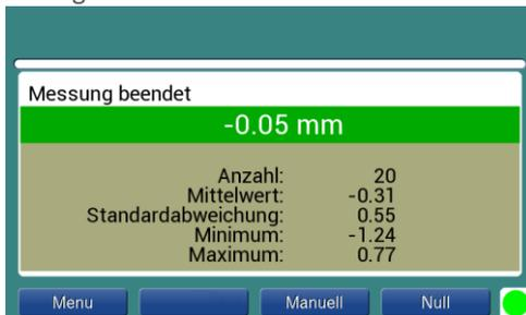
Hier befindet sich der Zugang zur manuellen Messung. Mit Start (oder mit Betätigung des Fußschalters) löst man die einzelne Messung aus. Die Anzeige erfolgt dabei grafisch und numerisch. Die Skalierung arbeitet wie bei der automatischen Messung beschrieben. Zurück ins Hauptmenü gelangt man mit „Beenden“.
